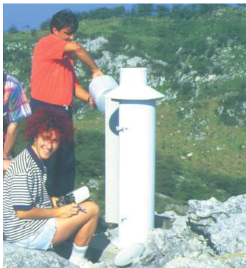
Figura 17. Estación pluviográfica de la Diputación Foral de Bizkaia en el macizo de Aramotz. La existencia de este tipo de instalaciones básicas, un tanto desfasadas si las comparamos con la instrumentalización y los medios tecnológicos con los que están dotadas las actuales estaciones automáticas de la red multiuso, constituyen parte de una infraestructura de nuestro pasado reciente que se debe seguir manteniendo, especialmente las situadas en zonas montañosas y de difícil acceso, como la presente, que contribuyen muy dignamente a cubrir importantes lagunas de información en el territorio.
